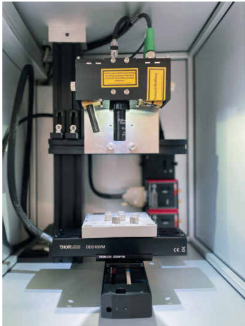
Mit der Laser-Speckle-Photometrie können fast alle Materialklassen zerstörungsfrei auf Defekte geprüft werden. Der kompakte Messaufbau besteht aus Laserdioden (links), Digitalkamera (Mitte) und Anregungsquelle (rechts). Bild: Fraunhofer IKTS
