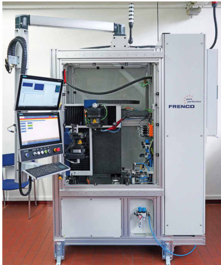
Die Aufstellmaße der Wälzprüfmaschine betragen 2 x 1 m. Bild: Frenco
