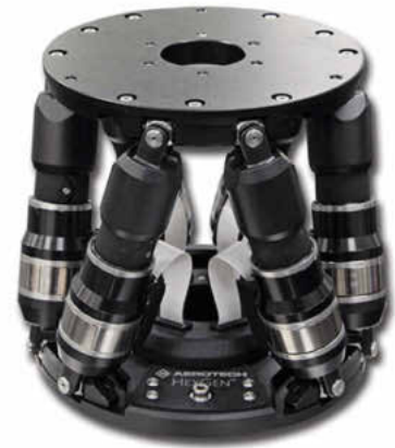
Bei Fahrbereichen von bis zu 55 mm linear und 50° Drehung kann der Hexapod Hex150-140HL bis zu 7,5 kg Nutzlast quasi vollkommen frei im Raum bewegen.
