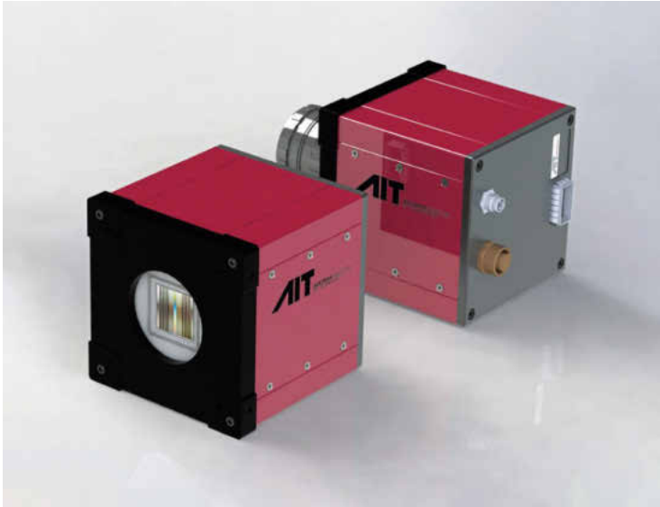
Mit Xposure:photometry stellt das AIT (Austrian Institute of Technology) ein System zur schnellen 2D- und 3D-Inline-Oberflächeninspektion vor. Durch die Kombination einer Xposurehigh-speed-Zeilenkamera mit der Xposure:flash-Beleuchtungstechnologie ist es möglich, kleinste 3D-Defekte auch auf herausfordernden Objektoberflächen (zum Beispiel metallisch, reflektierend oder dunkel) mit hoher Geschwindigkeit zu detektieren. Das System basiert auf dem Prinzip der photometrischen Stereobildgebung und ist für den Einsatz in der industriellen Qualitätskontrolle unter anderem zur Prüfung von Batteriefolien oder von Prägungen auf Verpackungen geeignet. Bild: AIT
