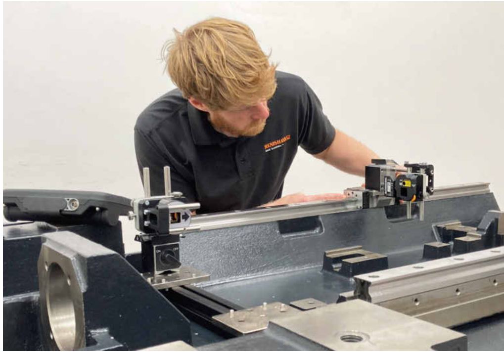
Präzise Parallelitätskorrekturen an einer Werkzeugmaschine auf einem Genauigkeitsniveau sind mit dem XK10 Geometrielaser möglich. Bild: Renishaw
