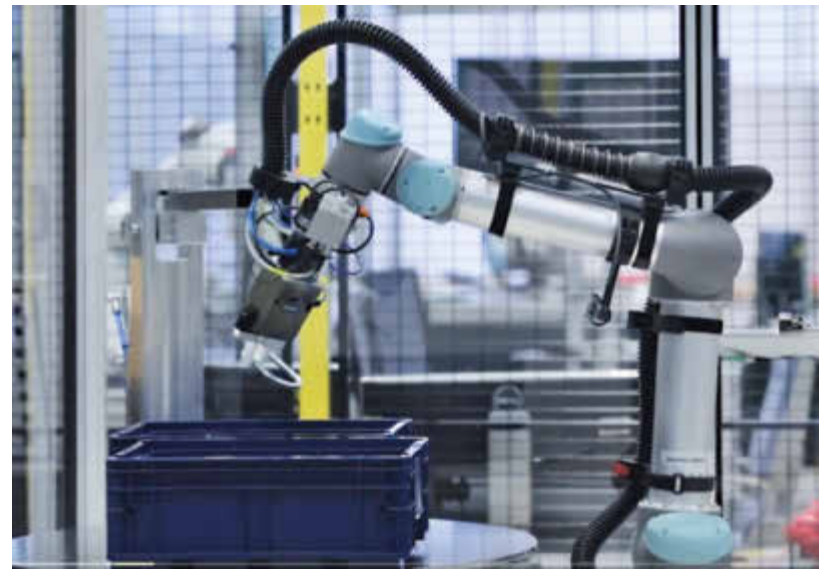
Der Roboter, der durch KI-basierte Algorithmen gesteuert wird, pickt Bauteile aus einer Kiste einzeln auf und positioniert sie korrekt vor drei unterschiedlichen Sensoren. Bild: Fraunhofer IPA
